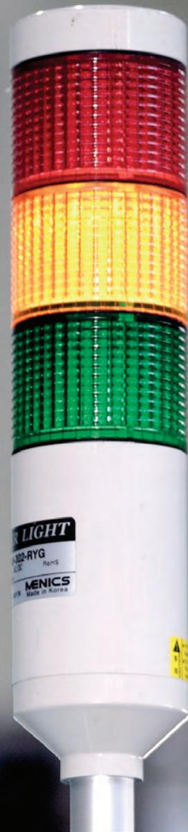
산업 설비 및 공정 제어 환경에서 장비에 일반적으로 사용되는 타워 램프 (동일명칭 : 타워 라이트 / 타워등)는 정확한 작업을 요하는 반도체 제조 장비, 공작 기계등 외부에서 장비의 운전 상황을 시각적·청각적으로 알려주는 표시기입니다.
